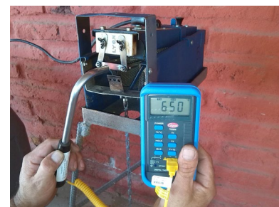
Пирометр показывает соответствующую температуру - 650°C.
